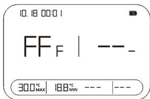
Если вы установили в ПО Freshliance параметр External – внешний датчик, но внешний датчик не подключили к регистратору, то на дисплее отобразятся буквы FFf, каждую минуту будет раздаваться звуковой сигнал тревоги и красный индикатор слева сверху корпуса регистратора будет моргать каждые 20 с. Подключите внешний датчик.
