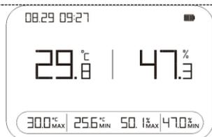
По центру дисплея отображаются текущие значения температуры (слева) и относительной влажности (справа) – только для режима Internal – внутренние датчики.
