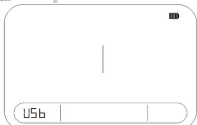
После остановки подключите регистратор к компьютеру: на дисплее регистратора отобразится **PdF** или **CSu** - отчёт формируется в выбранном вами ранее формате через ПО Freshliance и по окончании его формирования на дисплее отобразится **USB**.
